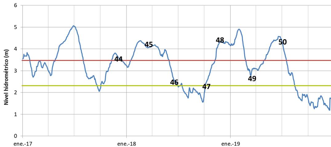
**Figura 4.** Niveles hidrométricos del puerto de Paraná, con ubicación de las campañas analizadas. La línea roja indica el nivel aproximado de la derrame de la planicie aluvial, y al línea verde, el de desconexión de los cuerpos de agua lénticos.
